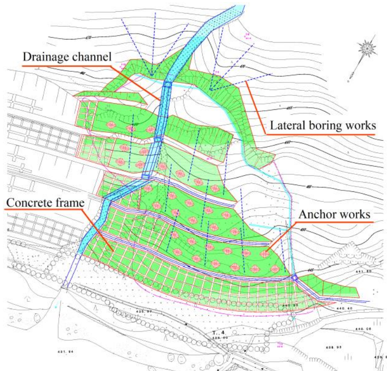
Hình 12. Sơ đồ bố trí công trình phòng chống sạt lở đất tại Mikabu
