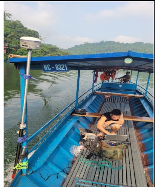
Hình ảnh đo sâu hồi âm mặt cắt hồ Ba Bể năm 2022
